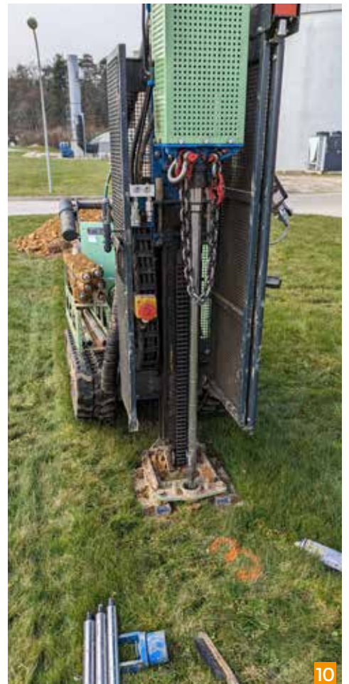
10/ Étude de sol en prévision de la construction de la chaufferie
